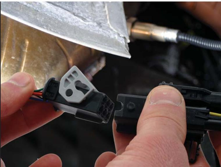
Sondenkabelbaum zum WBC Modul verlegen. Kabelbaum von Hitzequellen (z.B. Auspuff ) fernhalten. Kabelbaum so verlegen (z.B. Fig 1E) das er weder geknickt, gequetscht oder durchgescheuert werden kann.
