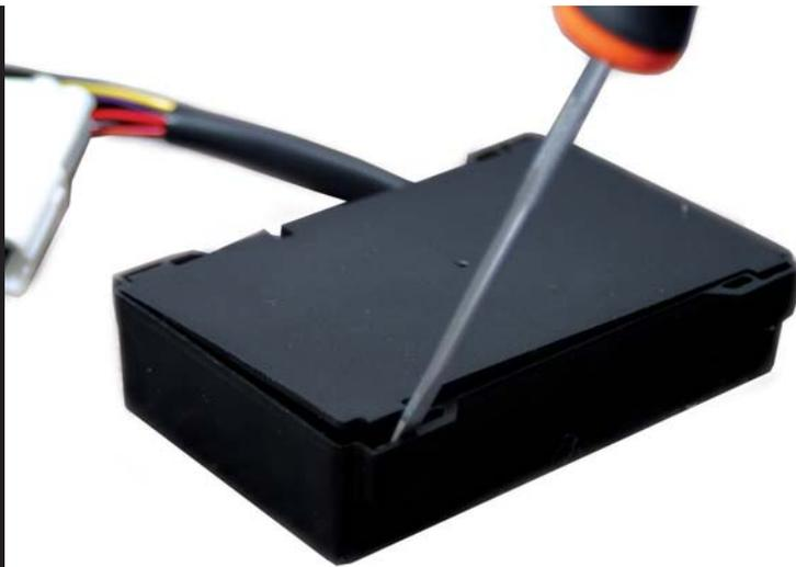
Den Lambdasondenkabelbaum, wie im Anschlusschema in FIG. 3D beschrieben, am Terminal anschliessen. Es wird empfohlen den Sondenkabelbaum, zur Zugentlastung, mit einem Kabelbinder am Hauptkabelbaum des WBC Modules zu befestigen (Fig. 3C). Rückwand des WBC Modules wieder schliessen.
