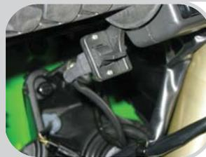
Abbildung zeigt, mit optionaler Halterung Etrn.#61329304, montierten Map-Schalter. Dieser Halter passt an Lenker mit einem Durchmesser von 22 mm.
